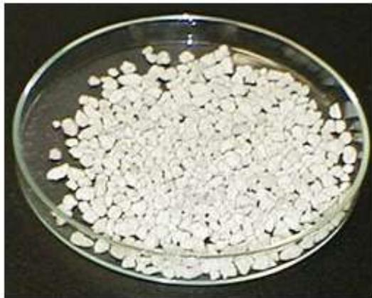
**Figura 43.** Arcilla de bentonita modificada con lantano (Phoslock)
